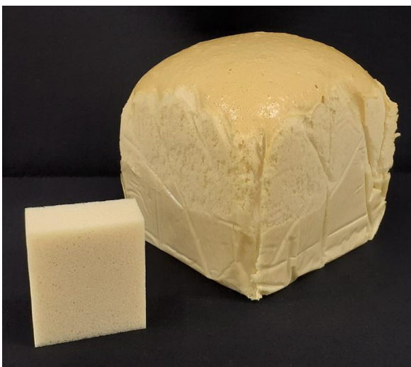
エボニックのケミカルリサイクル技術を用いて製造された、100%再生ポリオール由来のポリウレタンフォーム
