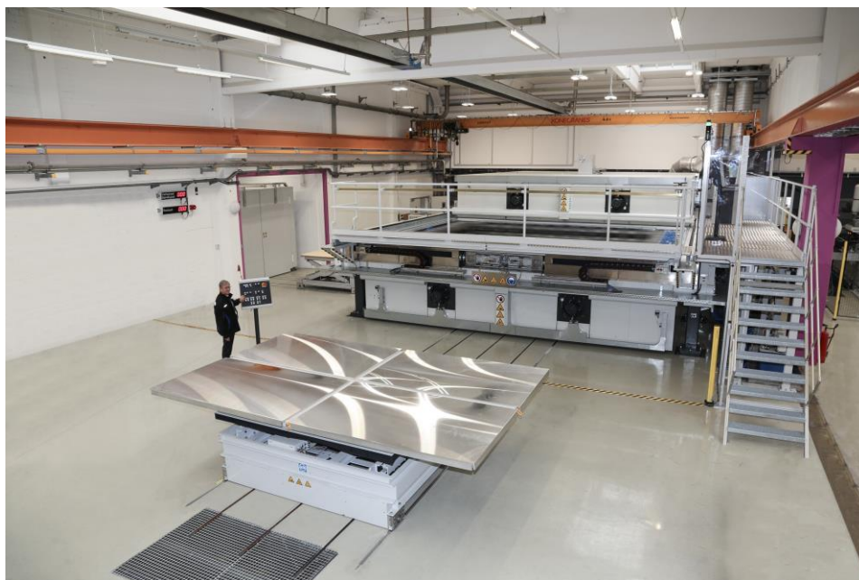
キャプション: 大型 PMMA ストレッチシートの加工プラント
