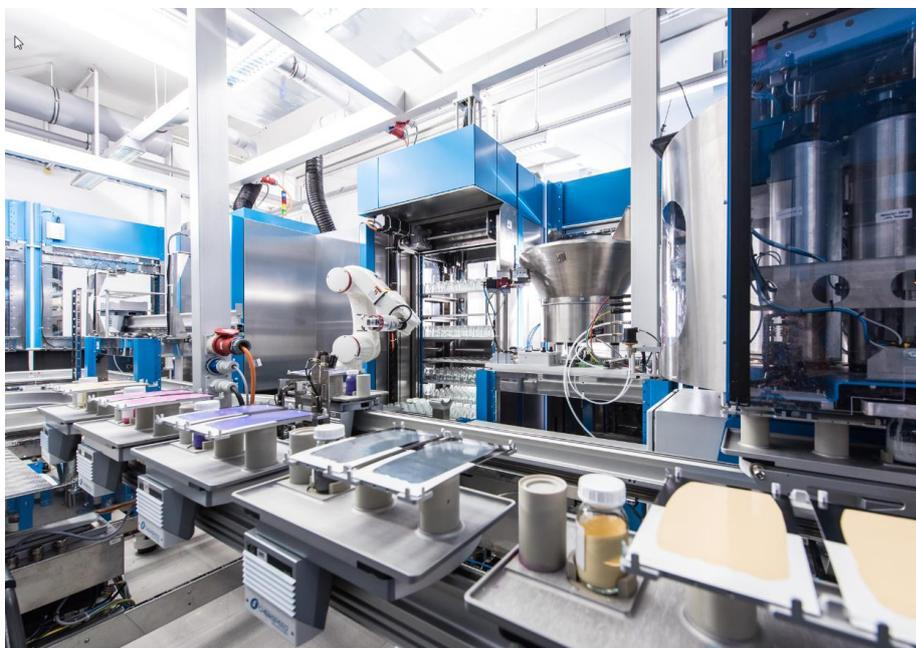
写真: エッセンにあるハイスループット自動試験設備では、1日に最高 120 のサンプルを配合し、試験することができます。
