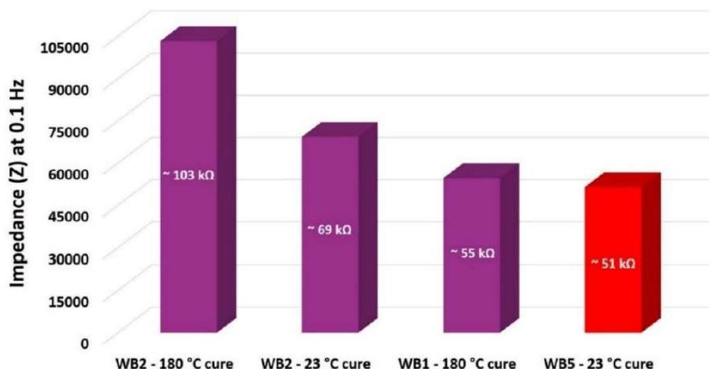
0.1Hz においては、WB1 液処理(180°Cキュア)のインピーダンス強度は 54.66k $\Omega$  それに Dynasytan®1146 を加えた WB2 液処理(23°Cキュア)のインピーダンス強度は 69.34k $\Omega$ 、キュア温度を 180°Cに上げるによりインピーダンス強度は 103.37k $\Omega$ に増加しています。つまり Dynasytan®1146 の添加により、キュア温度を上げずともインピーダンスは 27%増加し、加熱により 89%増加しています。一方市販品(WB5)液処理品のそれは 51.48 k $\Omega$ にとどまっています。
