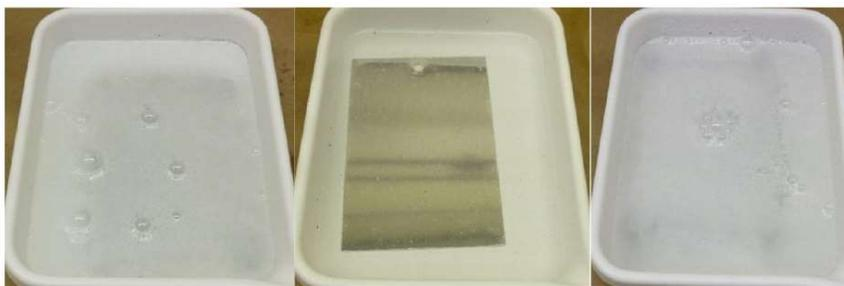
図 8 Al2024 T3 板 10%NaOH 水溶液に 6 分間浸漬
